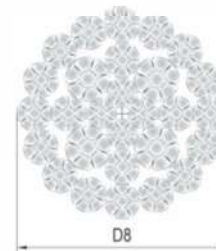
Поперечное сечение талевых канатов Wire rope cross section 8x26, Wire Strength 2160 N/mm 2 (Hol. ≤18) 8x26, прочность каната 2160 N/mm 2 (Выс. подъема ≤ 18)
