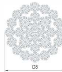
Поперечное сечение талевго каната Wire rope cross section 8x26, Wire Strength 2160 Н/мм² (Hol. ≤18) 8x26, прочность каната 2160 Н/мм² (Выс. подъема ≤ 18)
