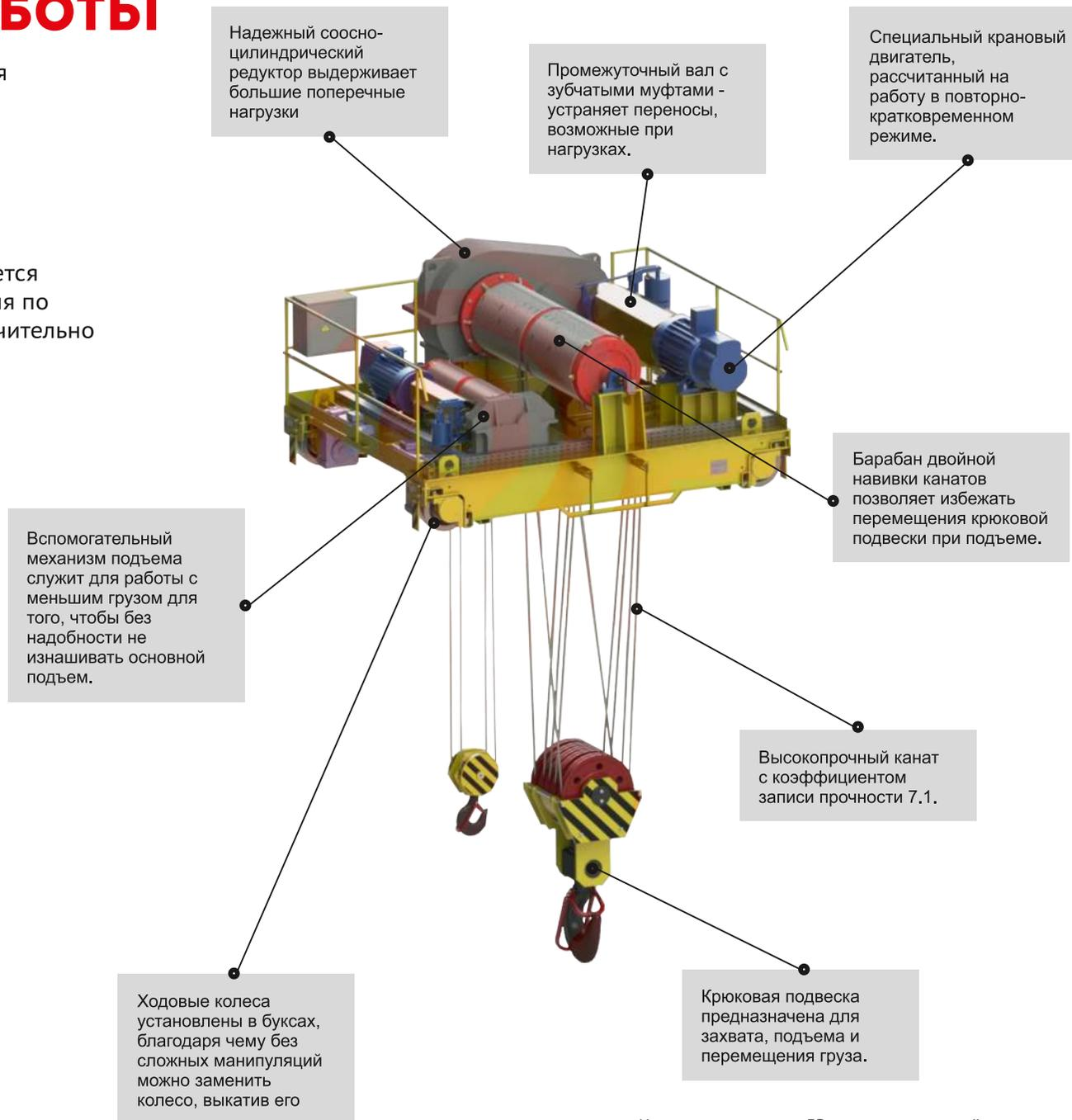
На рисунке показана 3D модель возможной конструкции.
