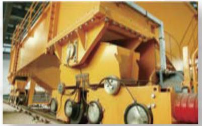
Концевые балки большой грузоподъемности
