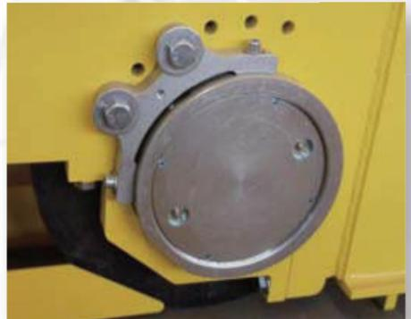
Регулируемый вертикальный наклон и горизонтальное отклонение
